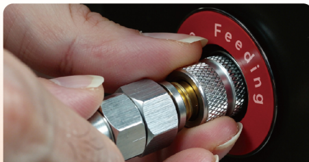
Быстроразъемные трубки для подачи проволоки Замена проволоки за 3 секунды без простоя станка
